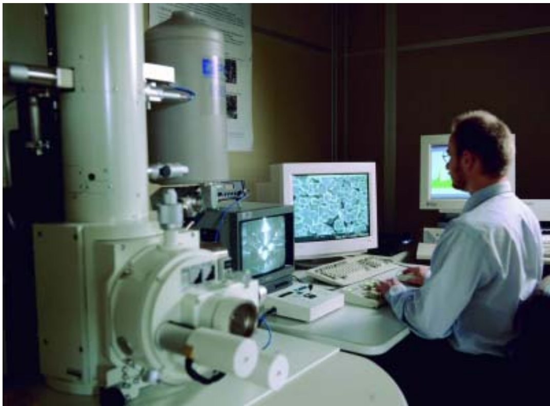
Analyse au microscope électronique de l'état de surface d'un échantillon de système FAP 2
