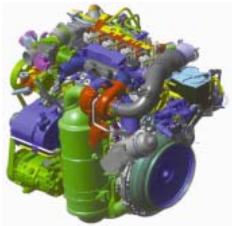
Maquette numérique du moteur HDi 1,6 l 2
