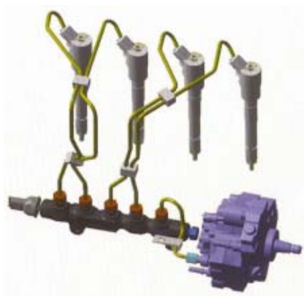
Maquette numérique du système d'injection du moteur HDi 1,6 l 2
