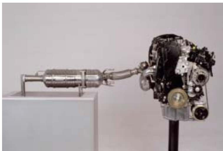
Moteur HDi 2,0 l avec échappement et système FAP 2
