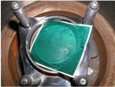
Un papier révélateur, chargé de particules métalliques, permet de visualiser les champs magnétiques générés par la cible
