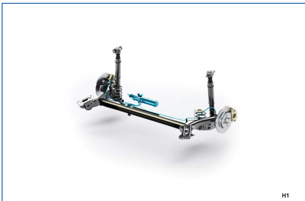
H3 : Zoom sur train arrière avec système Dynamic Rolling Control
